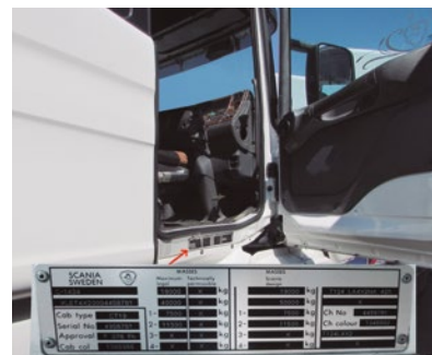
▶ Placa de fabricante Scania T en estribo derecho
