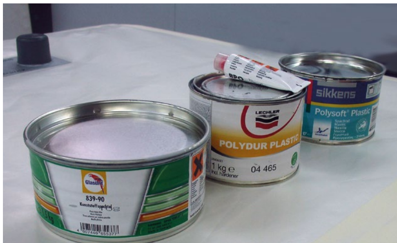
► Masillas elásticas con adherencia directa sobre plásticos
