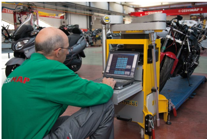
► Control de medidas del chasis
